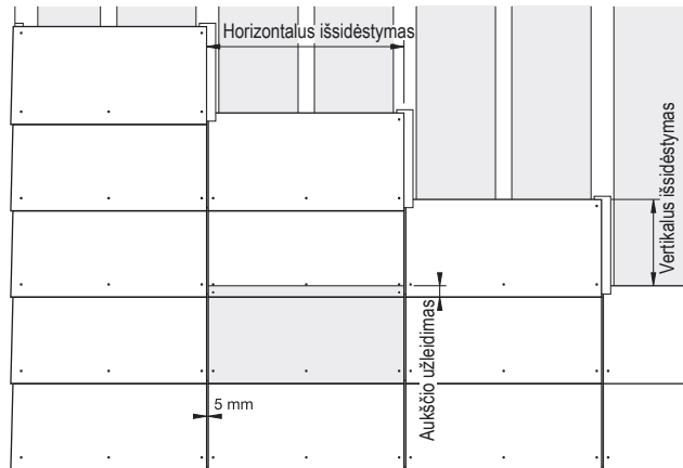
60 x 30 cm fasadinių plokštelių vertikalus dengimas
