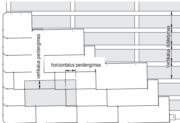
Horizontalus dengimas naudojant 60 x 30 cm formato plokšteles
