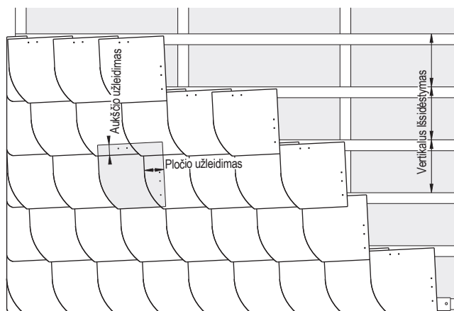
30 x 30 vokiškas fasadų dengimas su išgaubta kraštine
